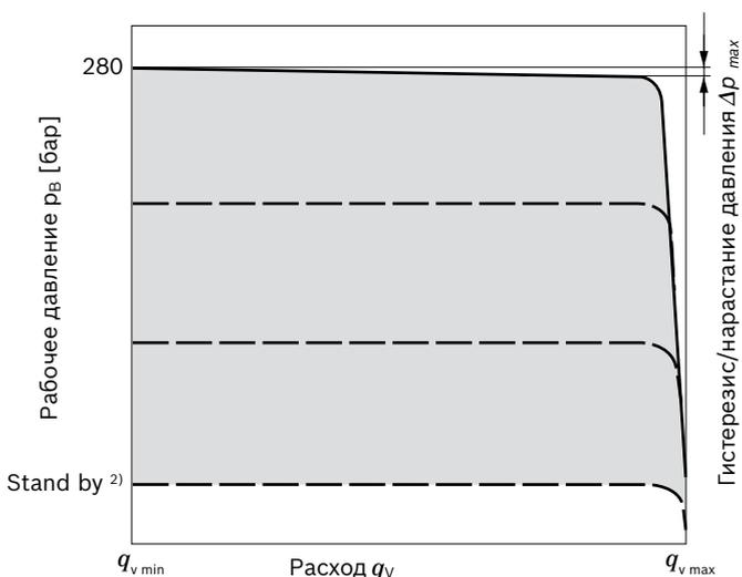
Характеристика действительна при  $n_1 = 1500 \text{ мин}^{-1}$  и  $t_{\text{fluid}} = 50 \text{ °C}$ .
