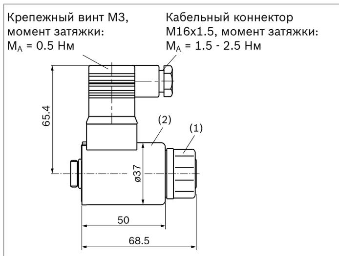
Уплотнительное кольцо в кабельном коннекторе подходит для диаметров кабеля от 4.5 мм до 10 мм.
