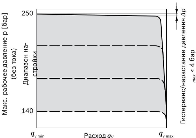
Характеристики действительны при  $n_1 = 1500 \text{ мин}^{-1}$  и  $t_{fluid} = 50 \text{ °C}$ .
