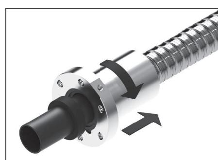
Удалить монтажную втулку только после того, как гайка полностью окажется на резьбе винта.
