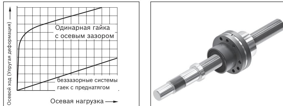
Системы гаек с преднатягом испытывают гораздо меньшую деформацию при изменении нагрузки, чем системы гаек без преднатяга. Поэтому системы гаек с преднатягом подходят для решения задач, характеризующихся повышенными требованиями к жесткости. В зависимости от нагрузки и времени работы на планетарной роликовинтовой передаче наблюдается потеря преднатяга. Жесткость винта заметно ниже, чем у гаек (более подробная информация в пункте «Общая осевая жесткость...»).
