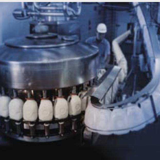
Выбор материалов для машин и аппаратов в пищевой и упаковочной промышленности также ориентируется на используемые средства и методы очистки. С другой стороны, при удачной с точки зрения гигиены конструкции очистка может быть выполнена за более короткое время, при более низких температурах, с использованием менее агрессивных очистителей, что также экономит время и уменьшает издержки.
