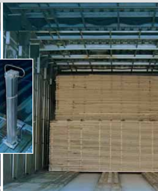
Просушивание досок под гнетом: это предотвращает их коробление
