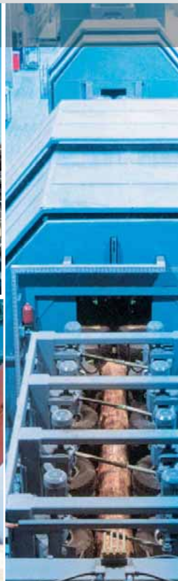
Пневматический цилиндр поджимает бревно при перемещении
